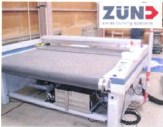
保温材プレカット用CAD/CAM機器例 (写真はシート状保温材加工用)
