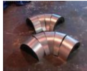
ベンチャークラッドをラミネートした保温材例
